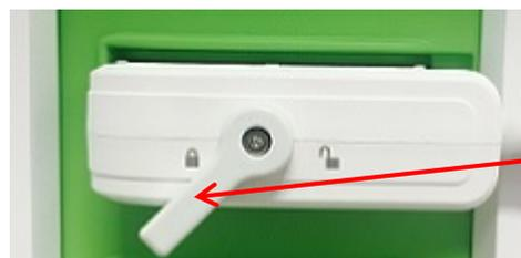
Figure 10 : Orientation du connecteur de la sonde
